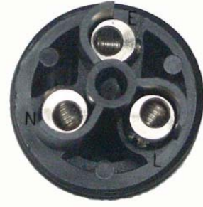
i Abbildung 5: Kabelverbindungen Braunes Kabel zum Anschluss L Blaues Kabel zum Anschluss N Grünes/gelbes Kabel zum Anschluss E
